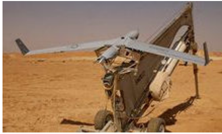
Een moderne variant van de katapult. Deze schiet kleine (onbemande) vliegtuigjes de lucht in!
